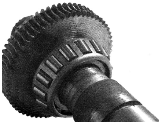
ภาพ 45 แบริ่งลูกปืนทรงกระบอกเรียว
