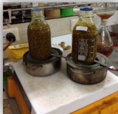
ภาพ 29 เทคนิคการสกัดแบบการอังด้วยไอน้ำ
